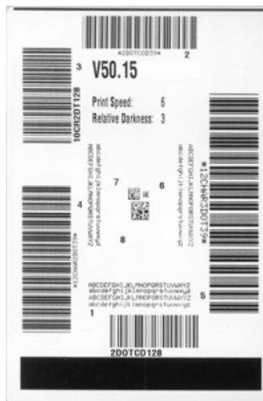
4. Vedere la [Figura 24](#) e la [Tabella 18](#). Esaminare le etichette di prova e individuare quella con la migliore qualità di stampa per l'applicazione. Se si possiede un verificatore di codice a barre, utilizzarlo per misurare le barre/gli spazi e calcolare il contrasto di stampa. Se non si possiede tale verificatore, utilizzare lo scanner del sistema o un controllo visivo per scegliere l'impostazione dell'intensità ottimale in base alle etichette stampate durante questo autotest.
